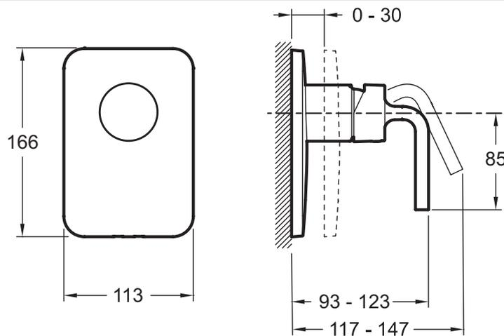
Спецификация продукта : Встраиваемый смеситель на 1 выход. E98709. Коллекция : PURIST. ВЕС : 1.9 кг. МАТЕРИАЛ : N/A. ТИП УСТАНОВКИ : Встраиваемые. TYPE D'ACCESSOIRE : 0. AVEC OU SANS ROBINETTERIE : 0. MITIGEUR : 0. TYPOLOGIE DE ROBINETTERIE DE DOUCHE : 0. FORME DE LA DOUCHE DE TÊTE : 0. INVERSEUR : 0. TYPE DE FLEXIBLE : 0. Комплектующие: встраиваемый смеситель, заглушки и ручка. Подключение: Подключение к выпускному отверстию (например: верхний душ, ручной душ).
