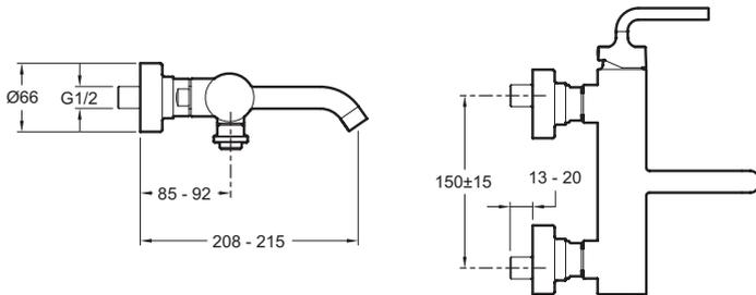
Descripción: Monomando baño-ducha mural - racores murales. E14589-4A. Colección: PURIST. PESO: 1,4 kg. Discreto inversor alrededor de la toma del flexo de ducha. Anillo limitador de temperatura. Aireador anticalcáreo.
