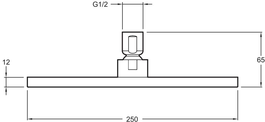
Спецификация продукта: Квадратный верхний душ 250 x 250 мм, современный дизайн. E13696. Коллекция: KATALYST. РАЗМЕРЫ (СМ): 25 x 25 см. ВЕС: 3,3 кг. АКСЕССУАРЫ: ВЕРХНИЙ ДУШ. НАЛИЧИЕ СМЕСИТЕЛЯ: 0. ОДНОРЫЧАЖНЫЙ СМЕСИТЕЛЬ: МЕХАНИЧЕСКИЙ. КЛАССИФИКАЦИЯ: МЕХАНИКА. ТИП СИСТЕМЫ: С СИСТЕМОЙ MODULO. ФОРМА ВЕРХНЕГО ДУША: 0. ПЕРЕКЛЮЧАТЕЛЬ: 0. ТИП ШЛАНГА: 0. Вращающийся верхний душ, антиизвестковое покрытие.
