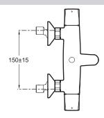
Спецификация продукта: Настенный смеситель для ванны/душа. E18874. Коллекция: ELEVATION. BEC: 2.5 кг. МАТЕРИАЛ: N/A. ТИП УСТАНОВКИ: Крепление к стене. D@BIT (L/MN SOUS 3 BARS): 21 л/мин. SAILLIE DU BEC (MM): 67 мм. M@CANISME: Кран-буксы с керамическим диском. ENTRAXE (MM): 150 ± 15 мм. GARANTIE FINITION: 10 лет.
